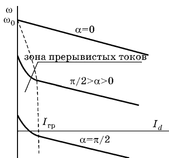
Рис. 7.29 Электромеханическая характеристика электропривода для режима прерывистых токов
